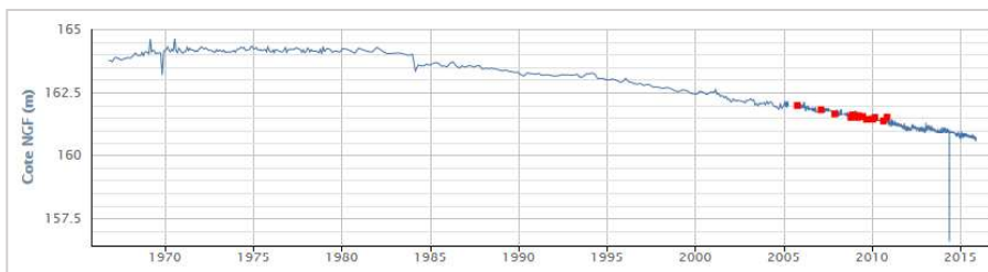
Figure 28 : Chronique piézométrique de la masse d'eau "FRFG082 - Sables, calcaires et dolomies de l'Eocène-Paléocène captif Sud Adour-Garonne " entre 1966 et 2015, à Eaunes Source : ADES Eau France - 10098A0004/F
